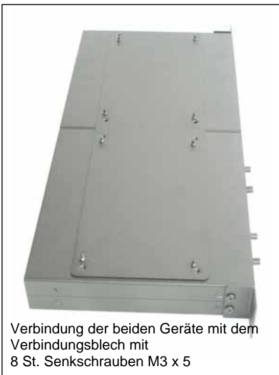
Montierte 19“-Einheit 1HE aus zwei 9,5“-Geräten
